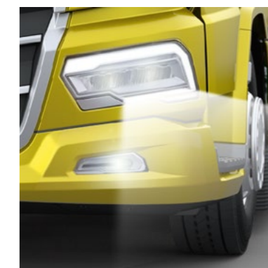
OSVETLENIE LED S PRISVETLOVANÍM DO ZATÁČKY A HMLOVÝMI SVETLAMI
