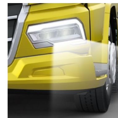
OSVETLENIE LED S PRISVETLOVANÍM DO ZATÁČKY
